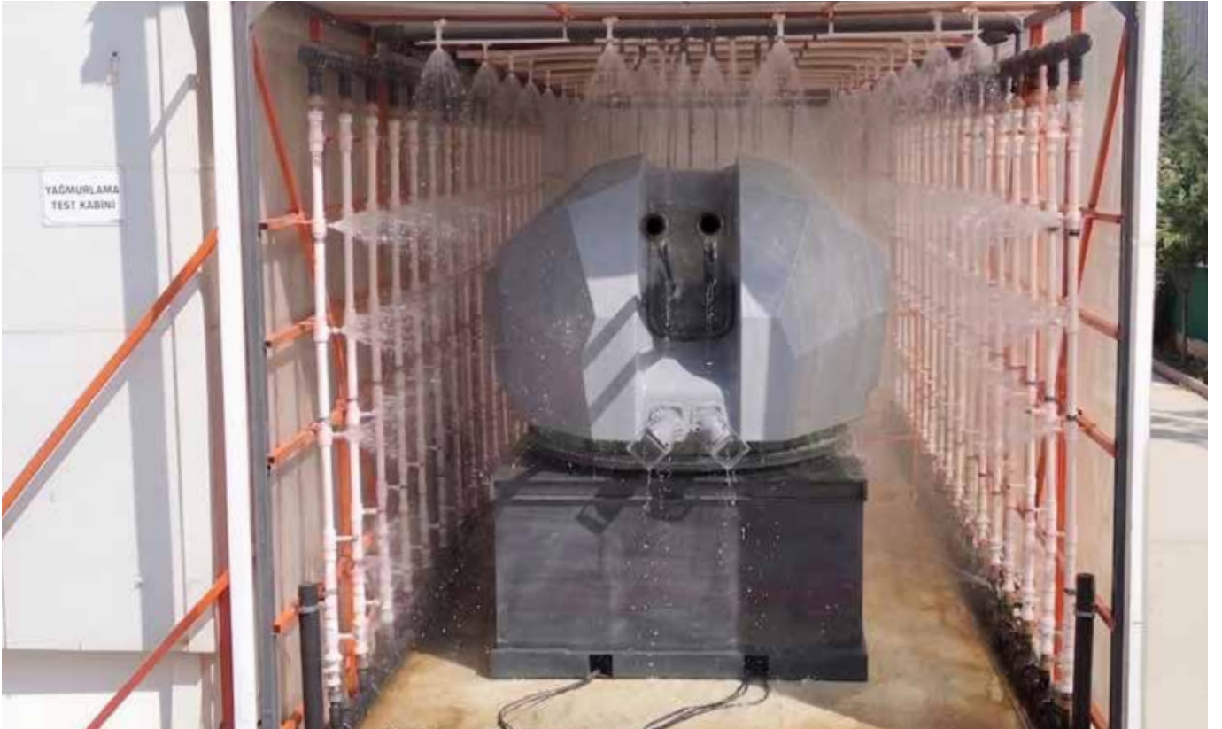
STEST, sistemlerin deniz platformlarında maruz kaldığı çevresel şartlara yönelik testleri gerçekleştirebiliyor.
