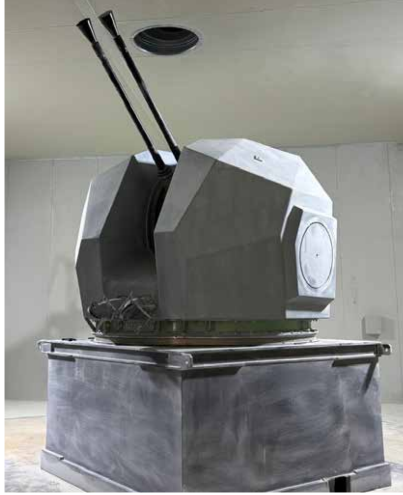
STEST, sistemlerin deniz platformlarında maruz kaldığı çevresel şartlara yönelik testleri gerçekleştirebiliyor.
